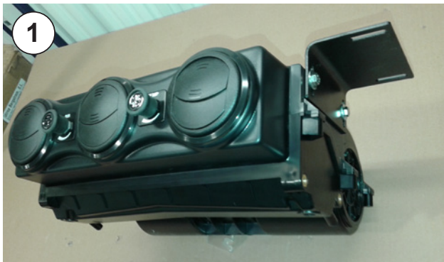
2- evaporador en techo
