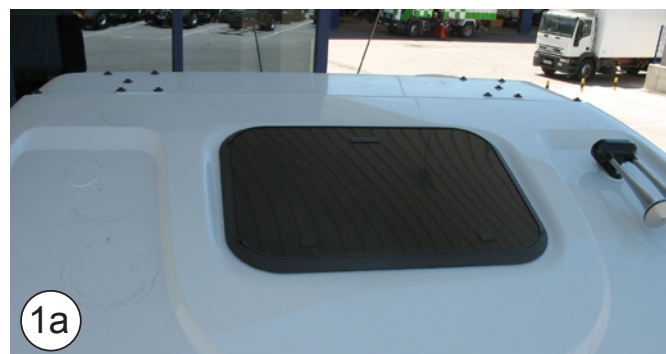
Kabina Stralis sprzed roku 2008: Uszczelka EPDM 40 x 40
