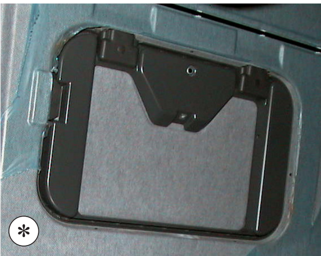
Standard-Fahrerhaus und Iveco Stralis seit 2008: EPDM-Dichtung 30 x 25
